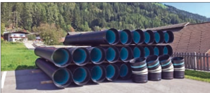
Schwerlastrohre aus Kunststoff (Durchmesser 60 cm).
